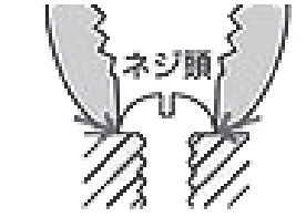
【図表4】ネジの保持力を高める構造
